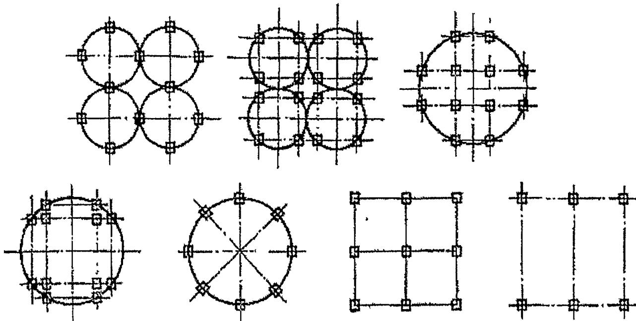
**Рисунок 4 – Схемы расположения колонн подсилосного этажа**
