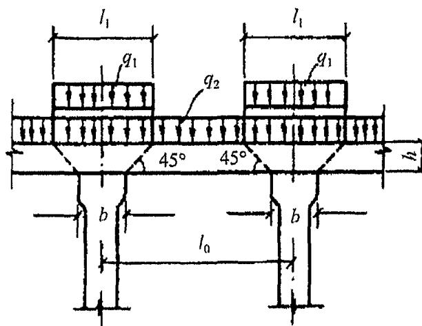
$q_1$  – нагрузка от стены силоса;  $q_2$  – нагрузка от днища (воронки);  $l_1$  – расчетная длина опирания стены силоса на балку;  $h$  – высота балки;  $b$  – ширина оголовка колонн;  $l_0$  – расстояние между осями колонн
