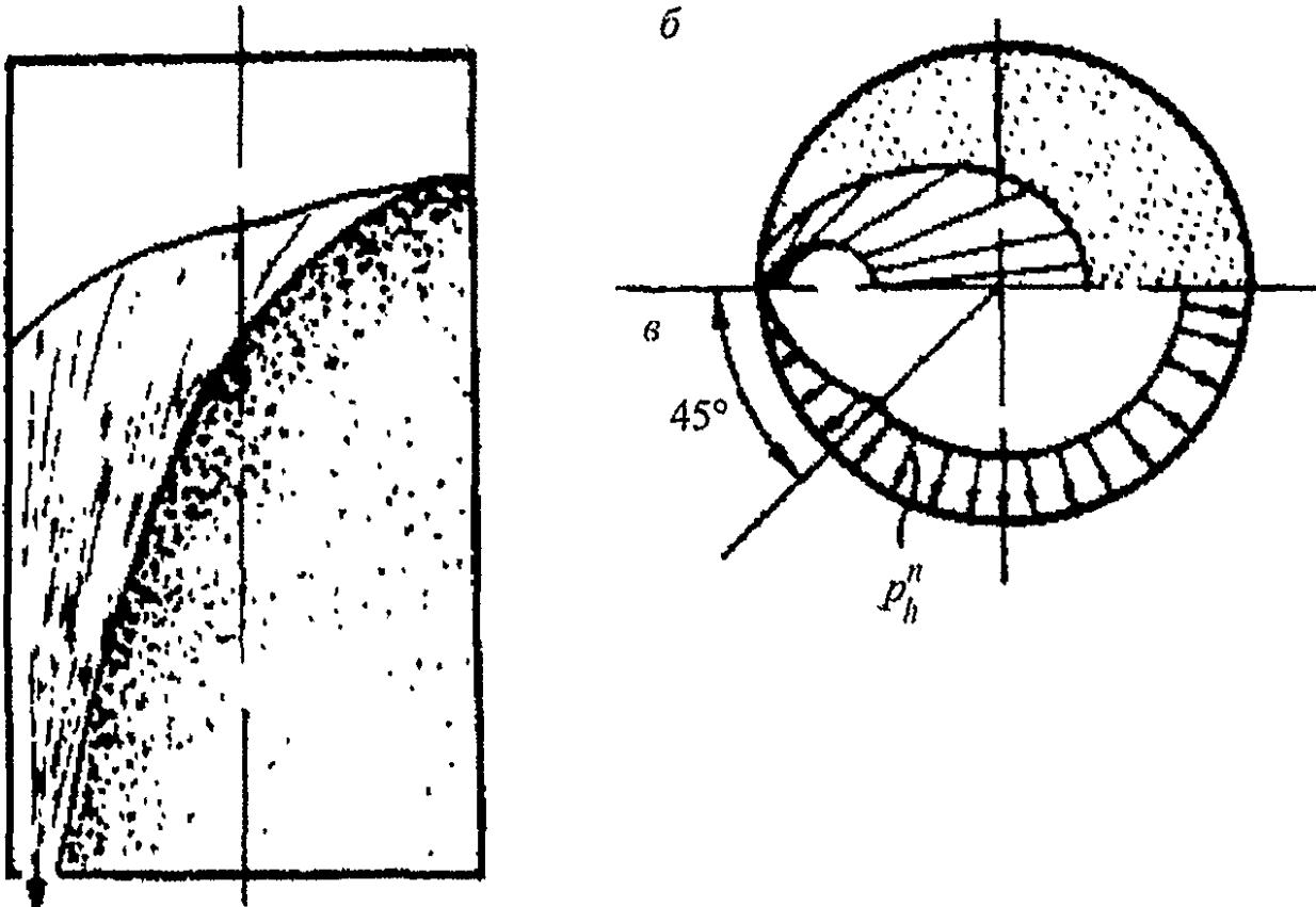
*a – разрез силоса; б – план; в – эпюра давления*
