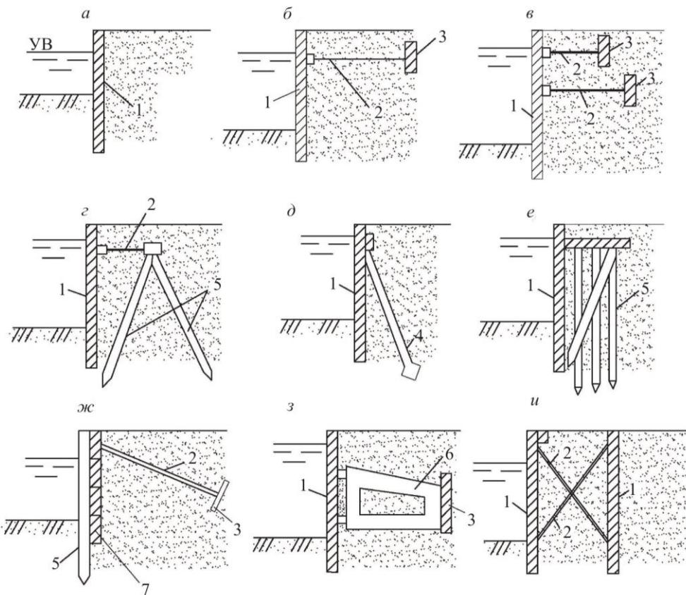
*a – безанкерные; б, в, г – заанкеренные одной или двумя тягами к плитам и сваям; д – заанкеренные к наклонным сваям; е – свайный ростверк с передним шпунтом; жс – забирчатого типа; з – заанкеренные с жестким (в том числе скользящим) анкерным устройством; и – в виде взаимозаанкеренных шпунтовых стен;*
