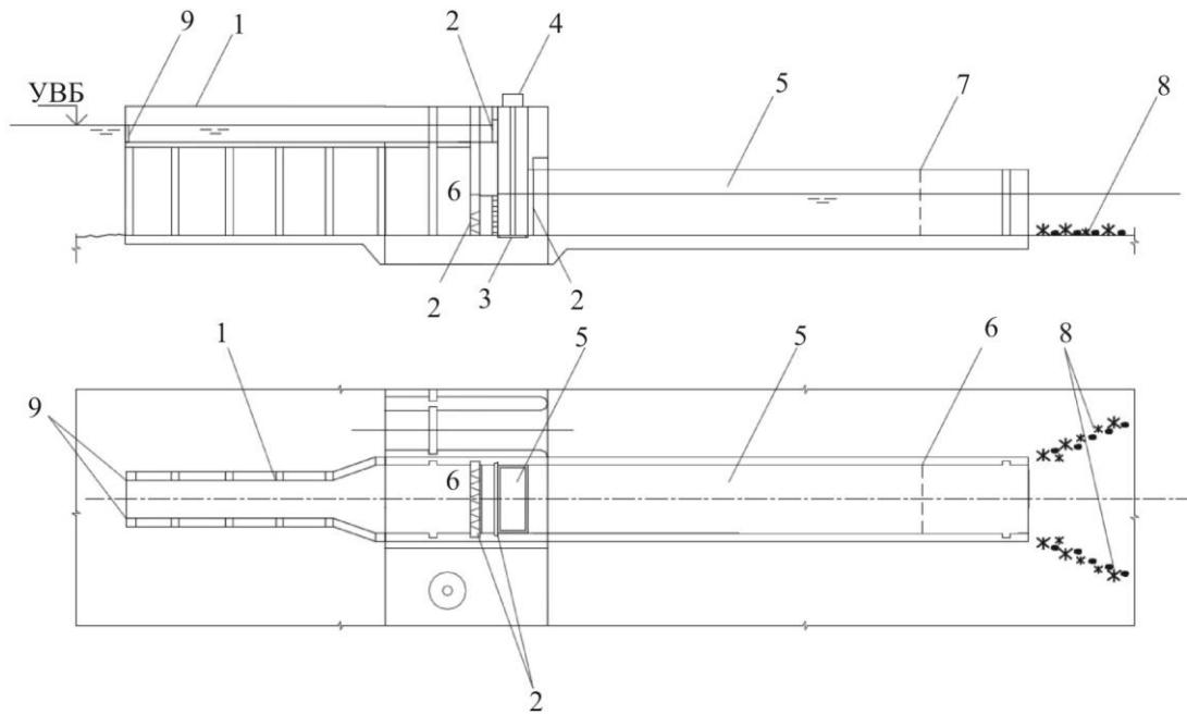
1 – верховой (выходной) лоток; 2 – затворы эксплуатационные; 3 – подъемная площадка; 4 – устройство для подъема площадки; 5 – рыбонакопитель; 6 – блок питания; 7 – побудительное устройство; 8 – рыбонаправляющие устройства; 9 – счетное устройство
