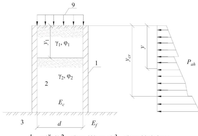
**Рисунок М.2 – Схема к расчету давления грунта на внутренние стены ячеек (оболочек)**
