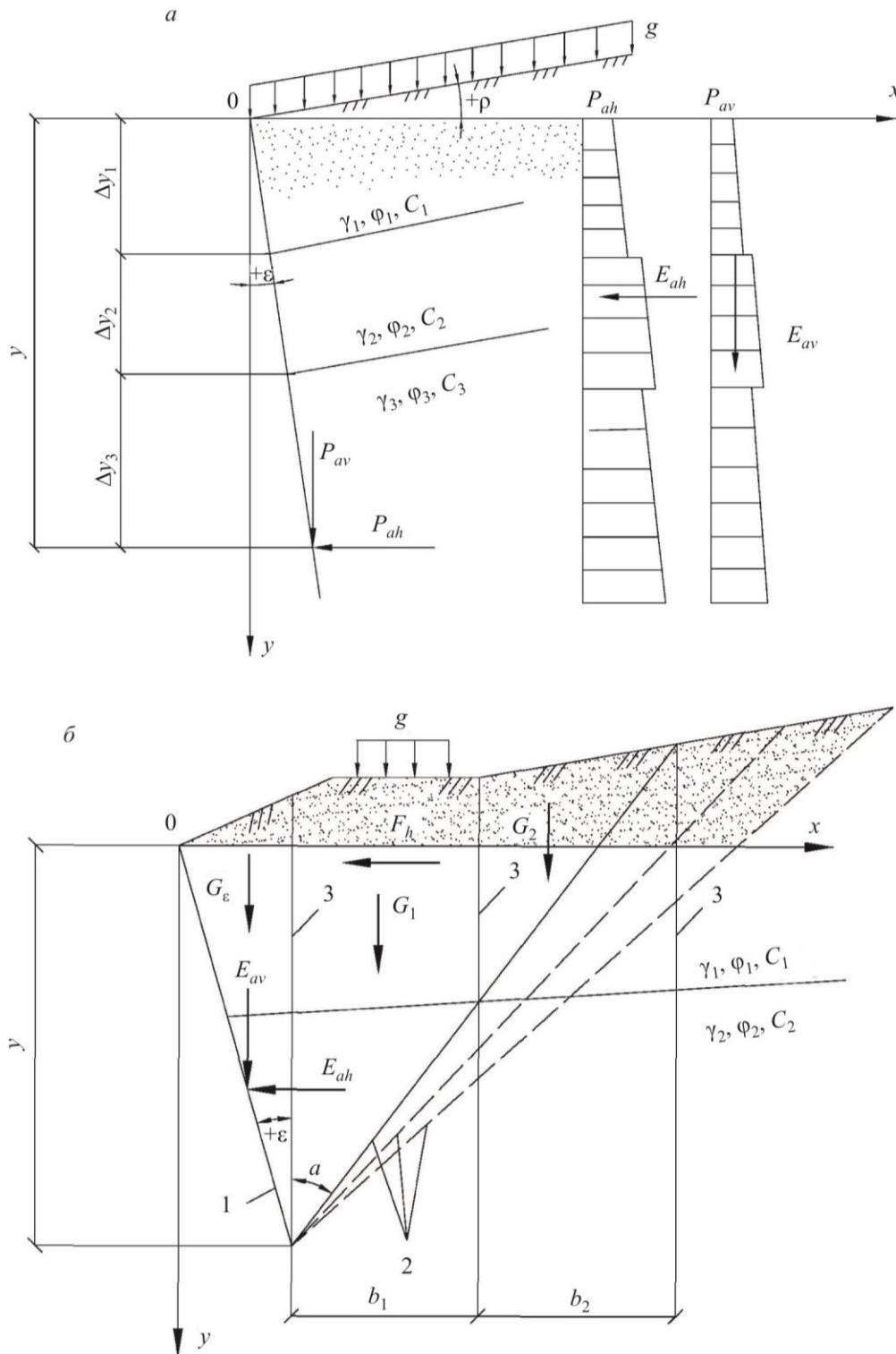
1 – расчетная плоскость; 2 – возможные поверхности обрушения; 3 – вертикальные плоскости раздела между элементами призмы обрушения
