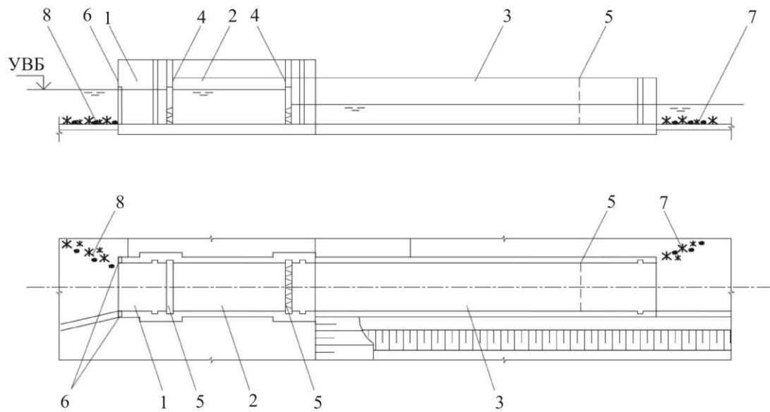
1 – верховой (выходной) лоток; 2 – аварийно-ремонтные заграждения; 3 – побудительное устройство; 4 – рыбонакопитель; 5 – затворы эксплуатационные с блоком питания; 6 – рабочая камера; 7 – счетное устройство
