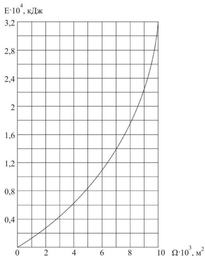
**Рисунок 7.4 – График для определения энергоемкости предохранительного устройства в зависимости от площади зеркала камеры шлюза**
