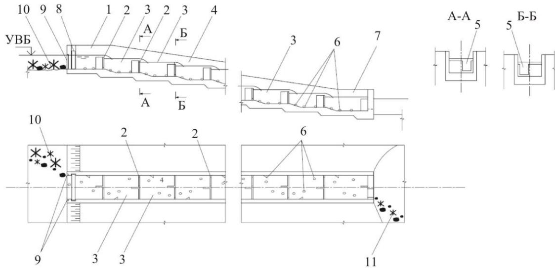
1 – верхняя голова; 2 – разделительная стенка; 3 – камеры тракта; 4 – тракт; 5 – всплывные отверстия; 6 – элементы искусственной шероховатости; 7 – входной оголовок; 8 – устройство для регулирования расхода; 9 – счетное устройство; 10 – искусственные ориентиры; 11 – рыбонаправляющие устройства
