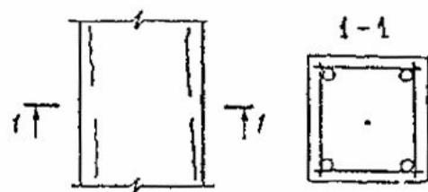
Рис. 6.3. Трещины вдоль продольной арматуры в сжатых элементах
