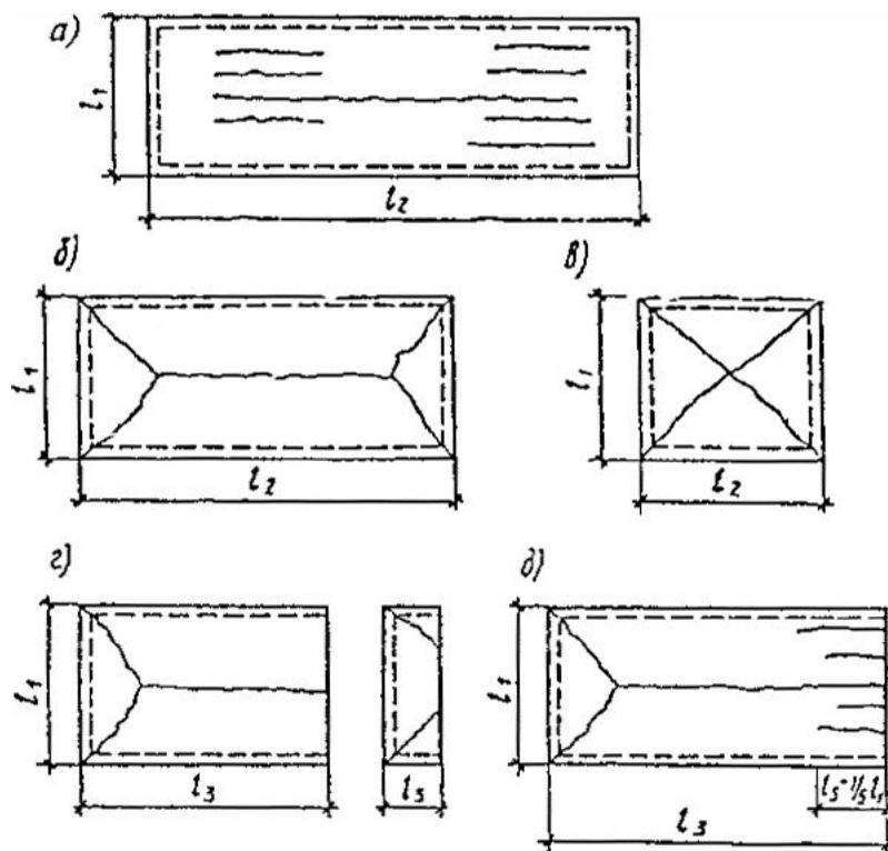
Рис. 6.2. Характерные трещины на нижней поверхности плит
