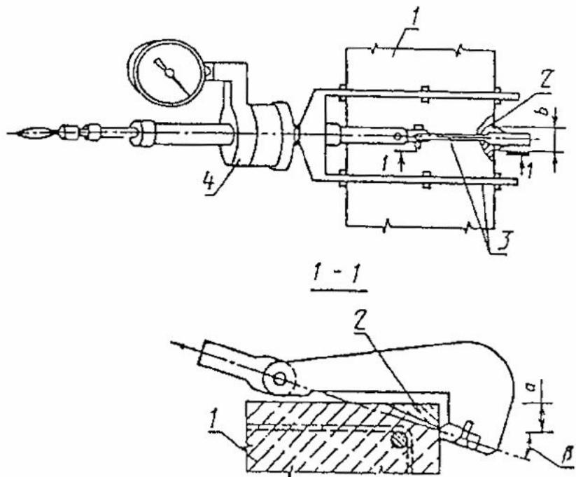
Рис. 6.15. Прибор для определения прочности бетона методом скальвания ребра
