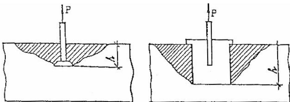
Рис. 6.13. Схема испытания методом отрыва со скальванием при использовании анкерных устройств
