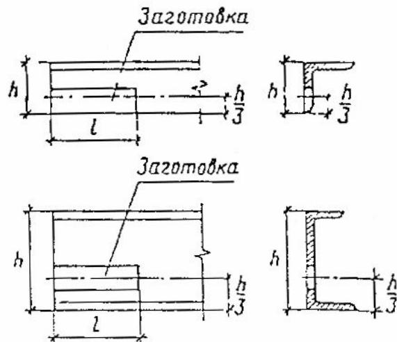
Рис. 8.7. Схема отбора заготовок из уголковых швеллерных сечений
