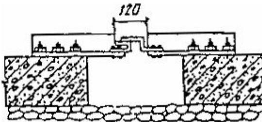
Рис. 5.12. Щелемер для измерения широких трещин и швов
