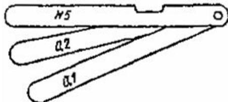
Рис. 5.5. Приборы для измерения раскрытия трещин
