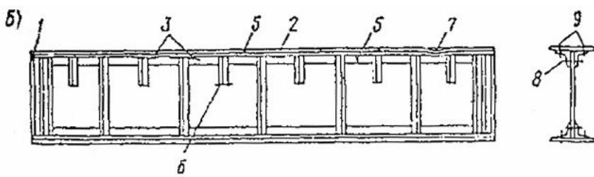
Рис. 8.3. Характер повреждения сварной (а) и клепаной (б) сплошностенчаных подкрановых балок
