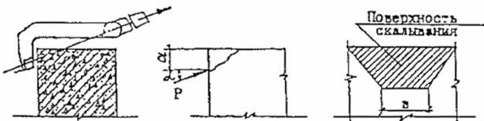
Рис. 6.16. Схема испытания бетона в конструкциях методом скальвания ребра конструкции
