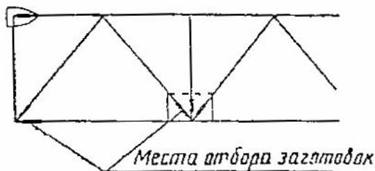
Рис. 8.6. Места отбора заготовок из элементов ферм
