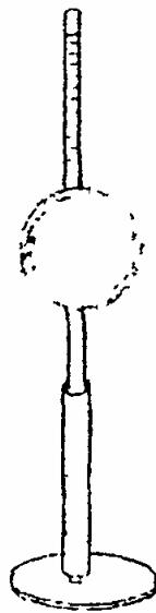
Рис. 3.9. Шаровой термометр
