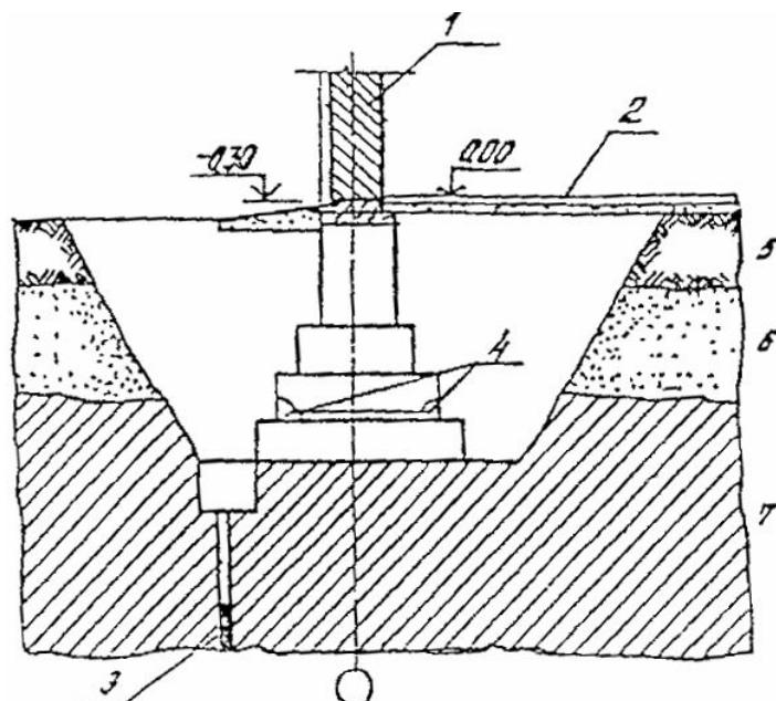
Рис. 12.1 Образец шурфа
