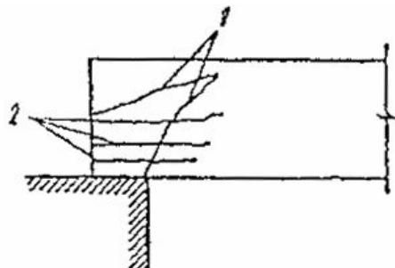
Рис. 6.5. Трещины в опорной части предварительно напряженного элемента
