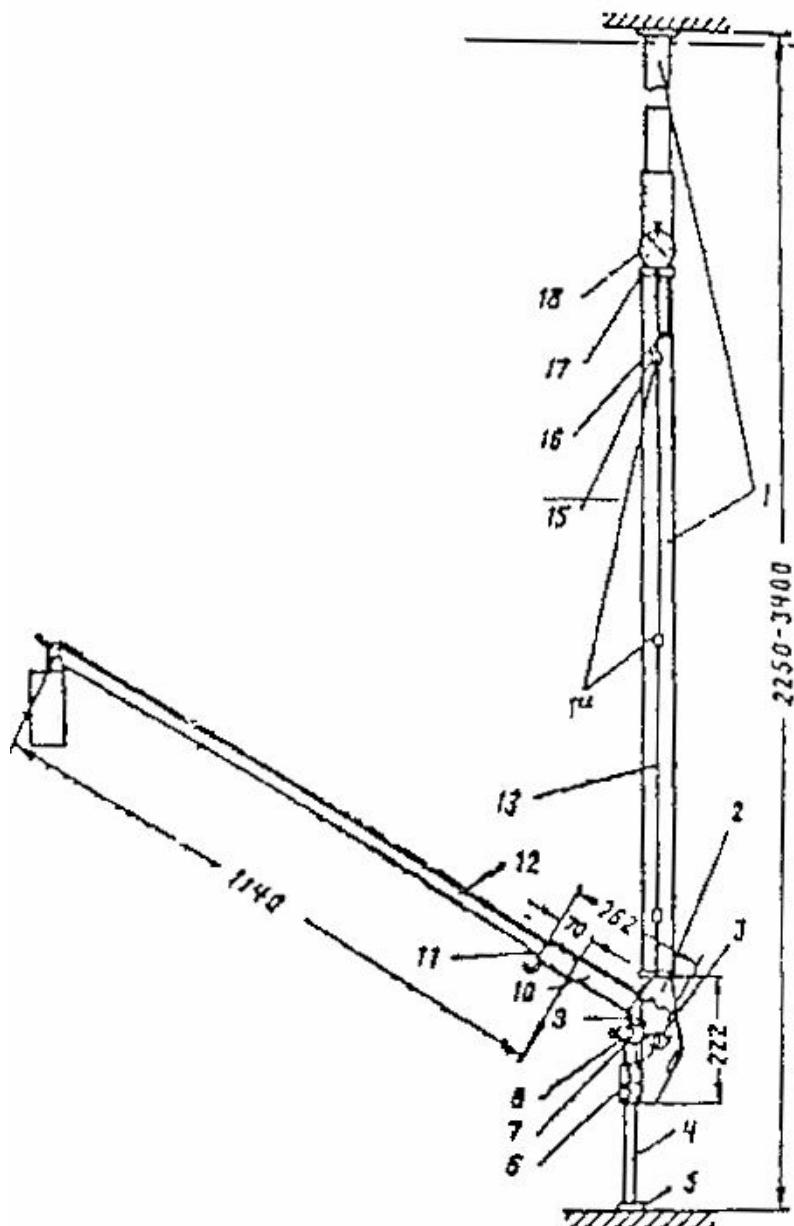
Рис. 11.1. Схема прибора для испытания полов под нагрузкой
