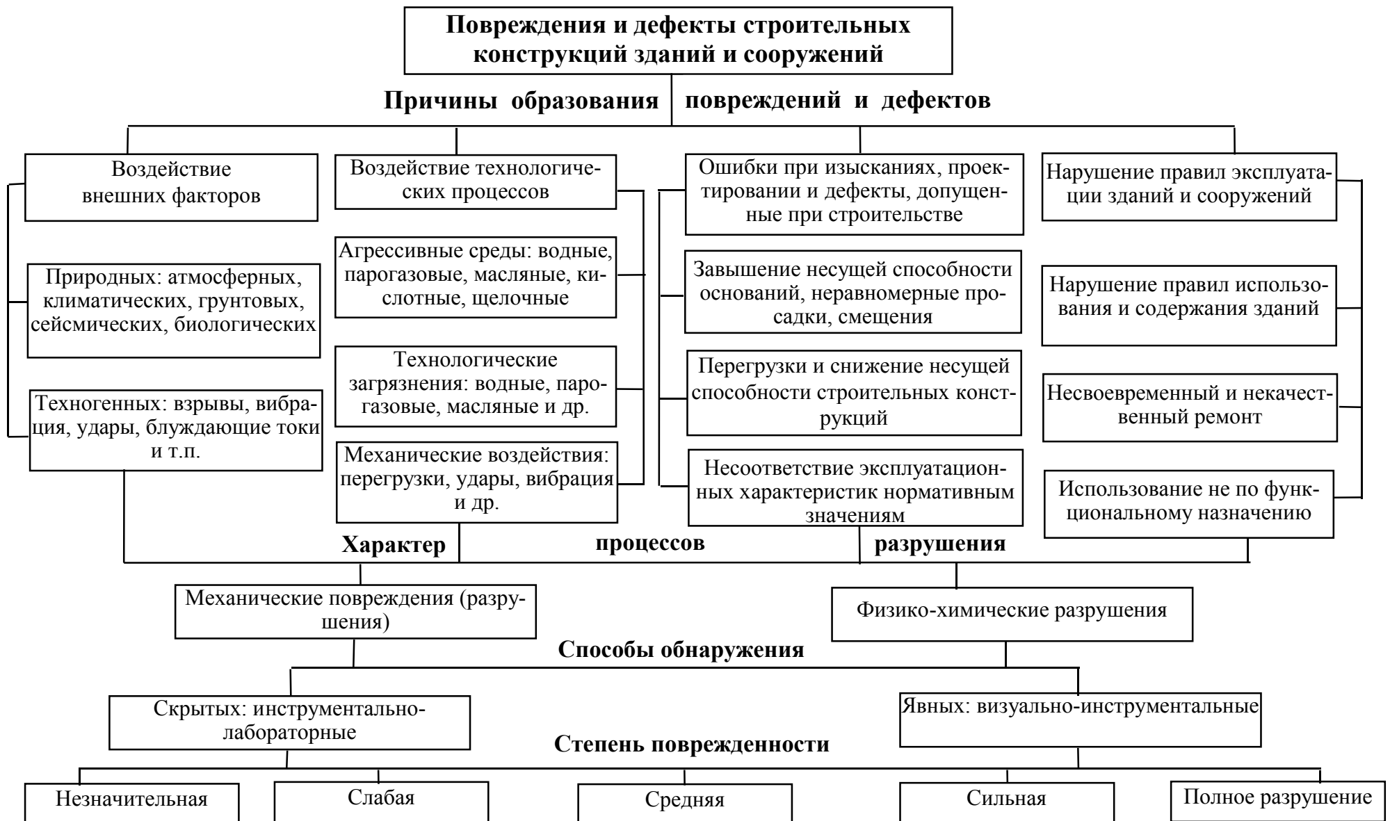
Рис. 3.1. Классификация повреждений и дефектов зданий и сооружений
