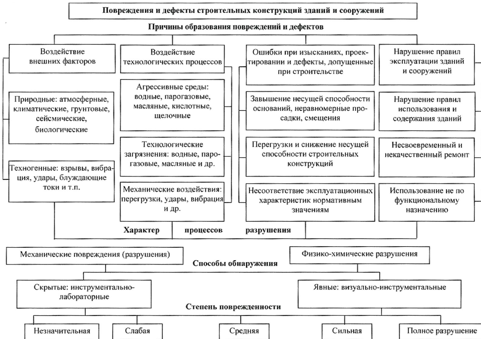
Рис. 3.1. Классификация повреждений и дефектов зданий и сооружений
